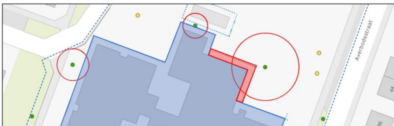
Figuur 8: Boomnummer 2. Vermindering in 2 meter werkgebied tijdens sloopwerkzaamheden, weergegeven in het rood.
