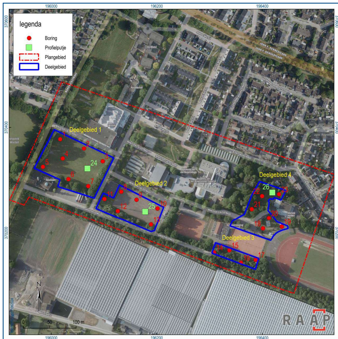
Figuur 2. Boringen en profielputjes.
