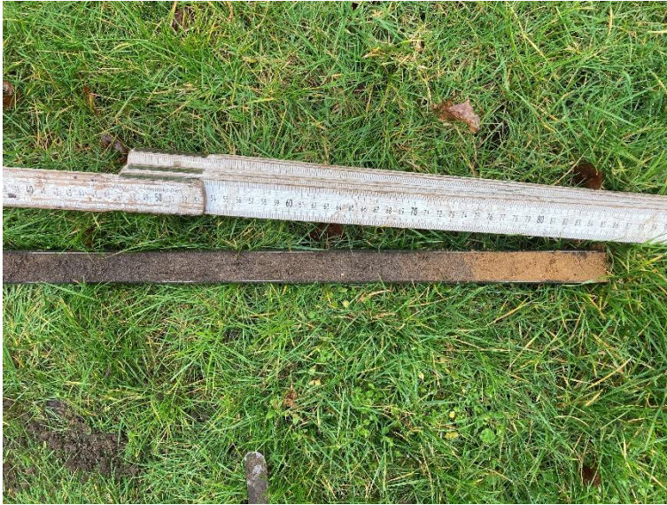
Boring 3 (tot 85 cm -Mv) scherpe overgang naar dekzand
