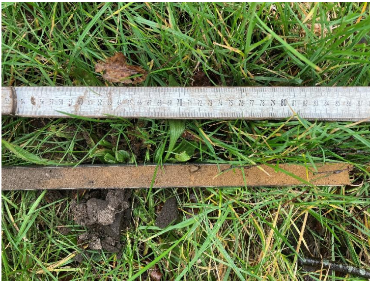
Boring 4 (tot 85 cm -Mv) bovengrond gaat hier al rond 55 cm -Mv over in natuurlijke ondergrond. Bovenin erg vuil qua vlekkerigheid.
