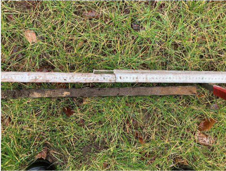
Boring 5 (tot 80 cm -Mv) wit zand in top en vlekkerige overgang naar natuurlijke ondergrond.
