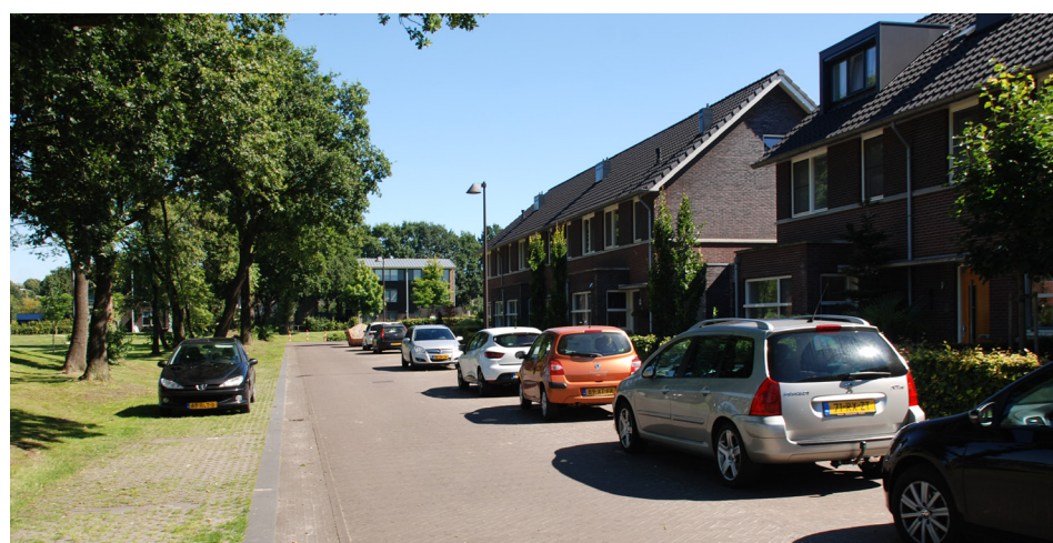
parkeren op halfverharding
