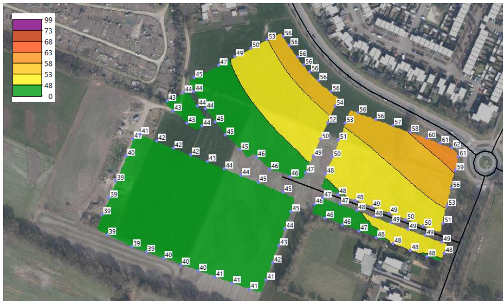
Figuur 4.2: Geluidsbelasting t.g.v. Van Geenstraat (inclusief correctie art. 110g Wgh.)
