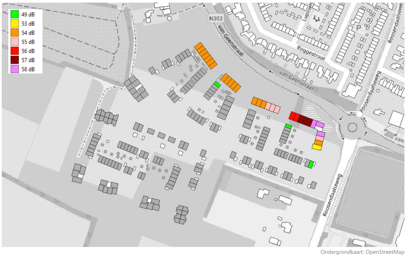
Figuur 4.8: Geluidsbelasting t.g.v. Van Geestraat (incl. correctie art. 110g Wgh.)
