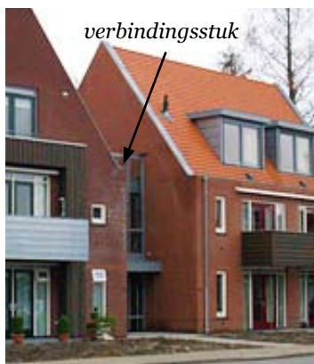
de verbindingsstukken liggen minimaal 4,5 m achter de rooilijnen van de zijvolumes, de bouwhoogte is maximaal 9,5 m
