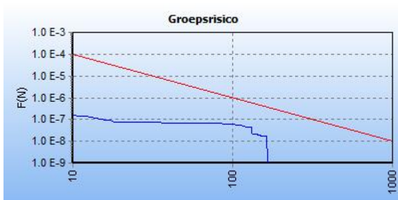
5.5 Figuur 5.5 FN curve voor 8461_leiding-N-570-26-deel-1 van N.V. Nederlandse Gasunie voor de kilometer tussen stationing 2480.00 en stationing 3480.00
