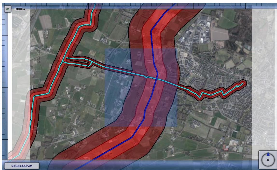
Afbeelding 5.1 1 % en 100 % letaliteitsafstanden van de buisleidingen in de nabijheid van de beoogde ontwikkeling (1 % donkerrood, en 100 % lichtrood)
