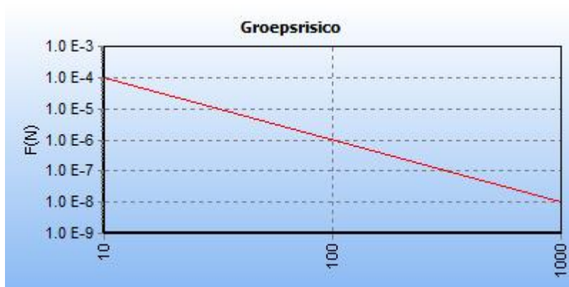
5.5 Figuur 5.5 FN curve voor 8461_leiding-N-570-26-deel-1 van N.V. Nederlandse Gasunie voor de kilometer tussen stationing 2480.00 en stationing 3480.00
