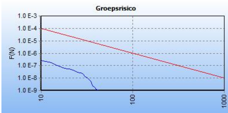
5.2 Figuur 5.2 FN curve voor 8461_leiding-N-570-16-deel-1 van N.V. Nederlandse Gasunie voor de kilometer tussen stationing 0.00 en stationing 620.00
