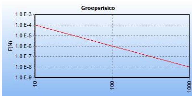
5.4 Figuur 5.4 FN curve voor 8461_leiding-N-570-20-deel-1 van N.V. Nederlandse Gasunie voor de kilometer tussen stationing 2380.00 en stationing 3380.00
