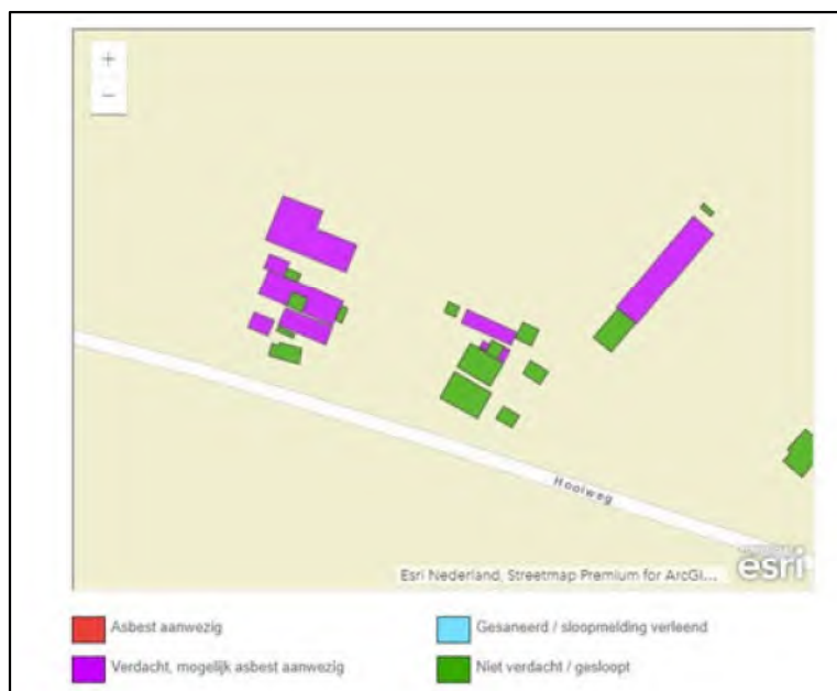
Figuur 3: asbestverdachte daken op de locatie
