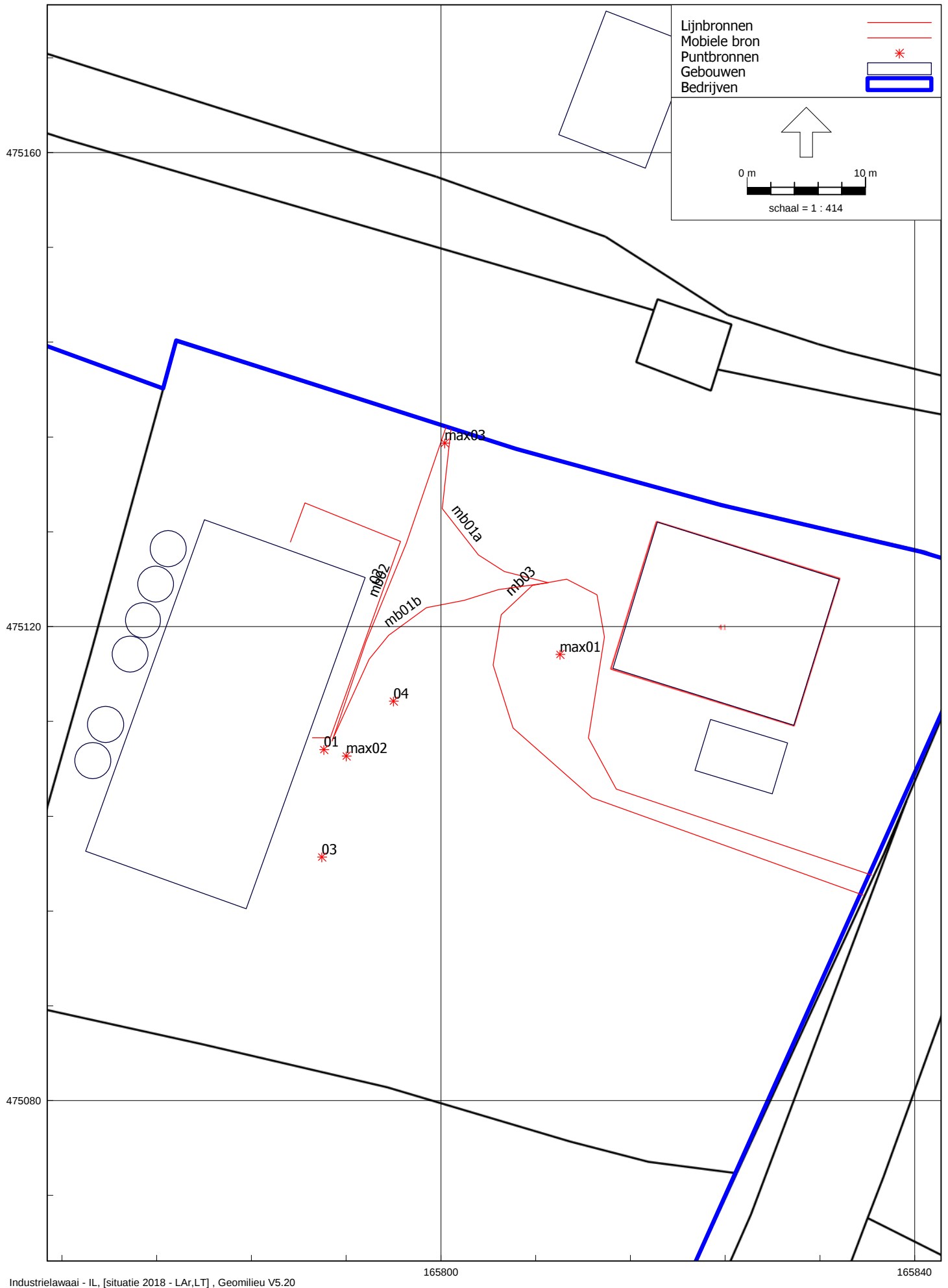
figuur 5: Overzicht rekenmodel met positie geluidbronnen
