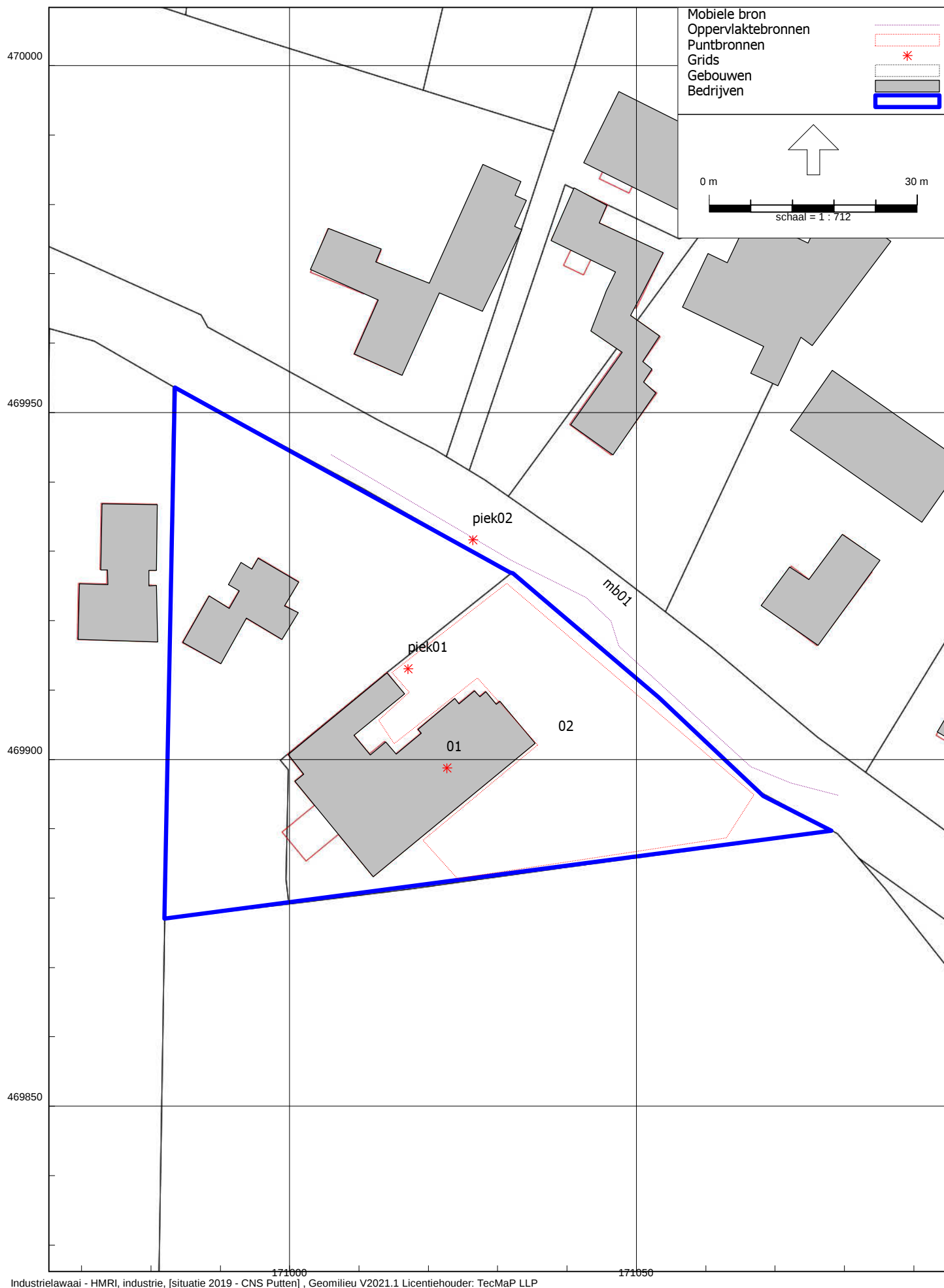
figuur 5: Overzicht rekenmodel met geluidbronnen
