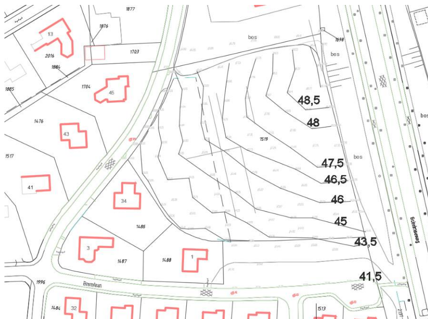
Figuur 14 Bestaande hoogtelijnen +NAP
