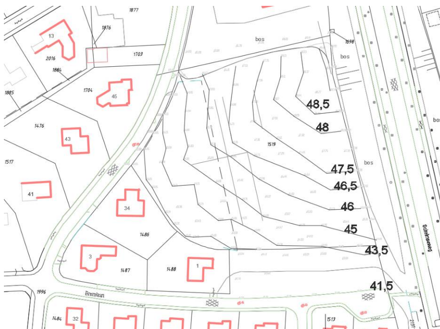
Figuur 8 Bestaande hoogtelijnen +NAP
