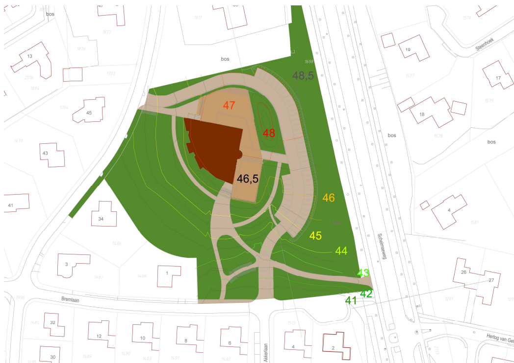
Figuur 19 Terreininrichting op hoofdlijnen, met hoogten +NAP.
