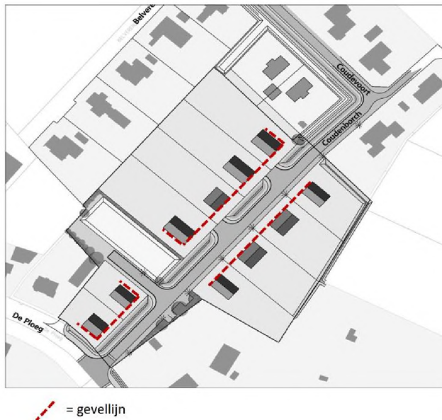
Figuur 4, principe van gevellijnen
