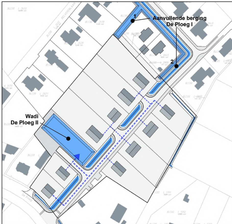
Figuur 4.3: Opzet globale hemelwaterbehandeling De Ploeg II (ondergrond is Definitief ontwerp d.d. 24 maart 2015)
