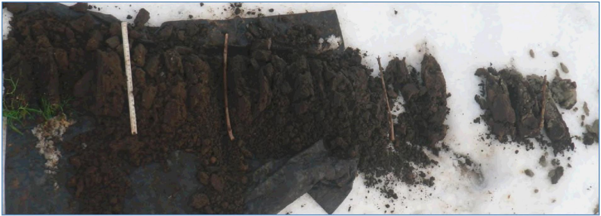
Abbeelding 20. De in drie groepen van 50 cm van links naar rechts uitgelegde boring 10. De witte schaalstok is 25 cm. Het gr.jze zandpakket betreft hoogstwaarschijnlijk verspoeld dekzand (beekbeddingsediment).
