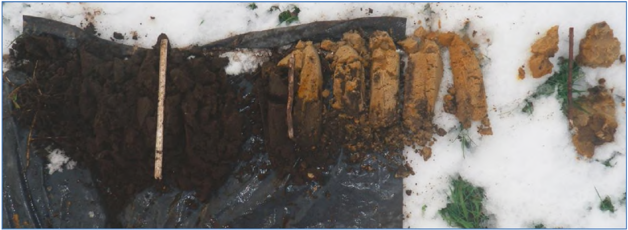
Afbeelding 18. De in twee groepen van 50 cm en een van 20 cm van links naar rechts uitgelegde boring 5. De witte schaalstok is 25 cm. Het beige zandpakket is afgetopt.
