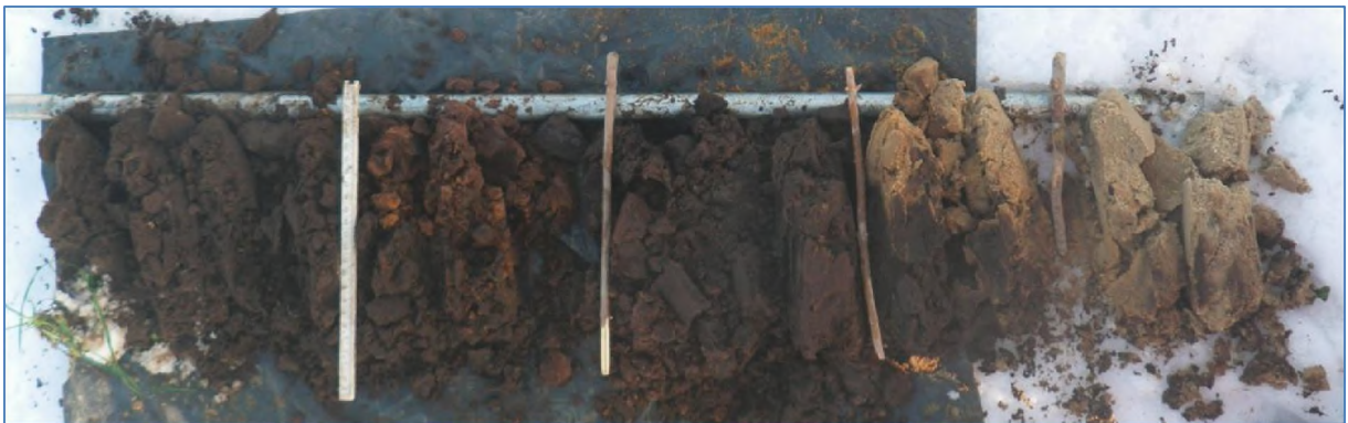
Afbeelding 19. De in twee groepen van 50 cm en een van 20 cm (rechts van het meest rechtse stokje) van links naar rechts uitgelegde boring 3. De witte schaalstok is 25 cm. Het beige gr.jze zandpakket is intact dekzand.
