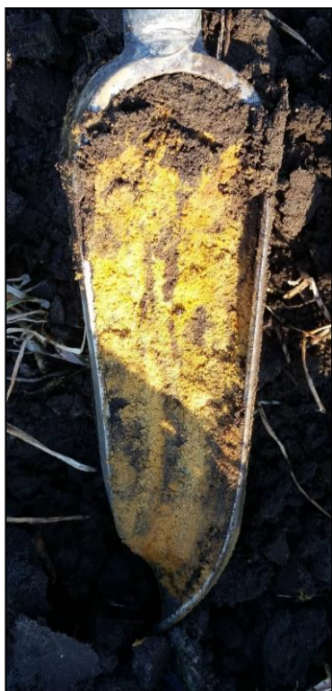
Figuur 7: Laag 2 zoals waargenomen in de boorkop ter plaatse van boring 3.
