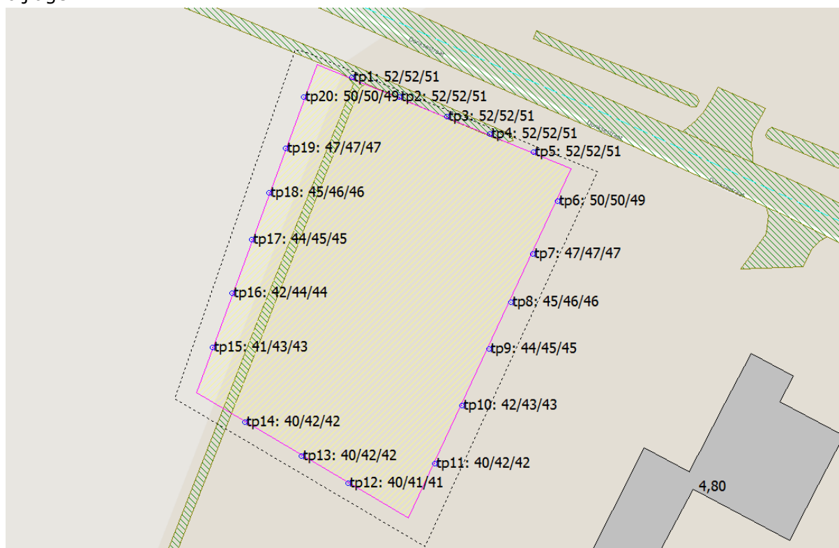
Afbeelding 5. Geluidbelastingen L_{den} (incl. aftrek art. 110g Wgh) Donksestraat
