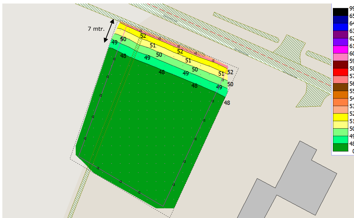
Afbeelding 6. Geluidscontouren Donksestraat (incl. aftrek art. 110g Wgh)
