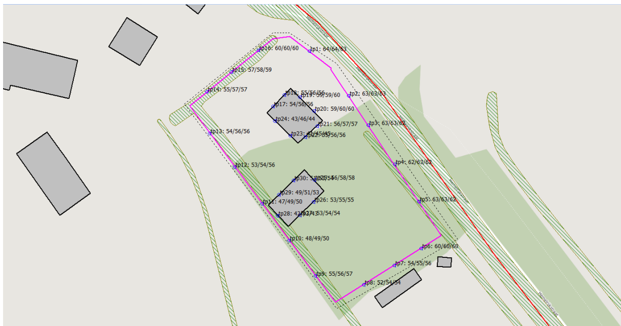
Afbeelding 11. Geluidbelastingen L_{den} (excl. aftrek art. 110g Wgh) cumulatief Berekende geluidbelastingen op een hoogte van 1,5 / 4,5 / 7,5 meter
