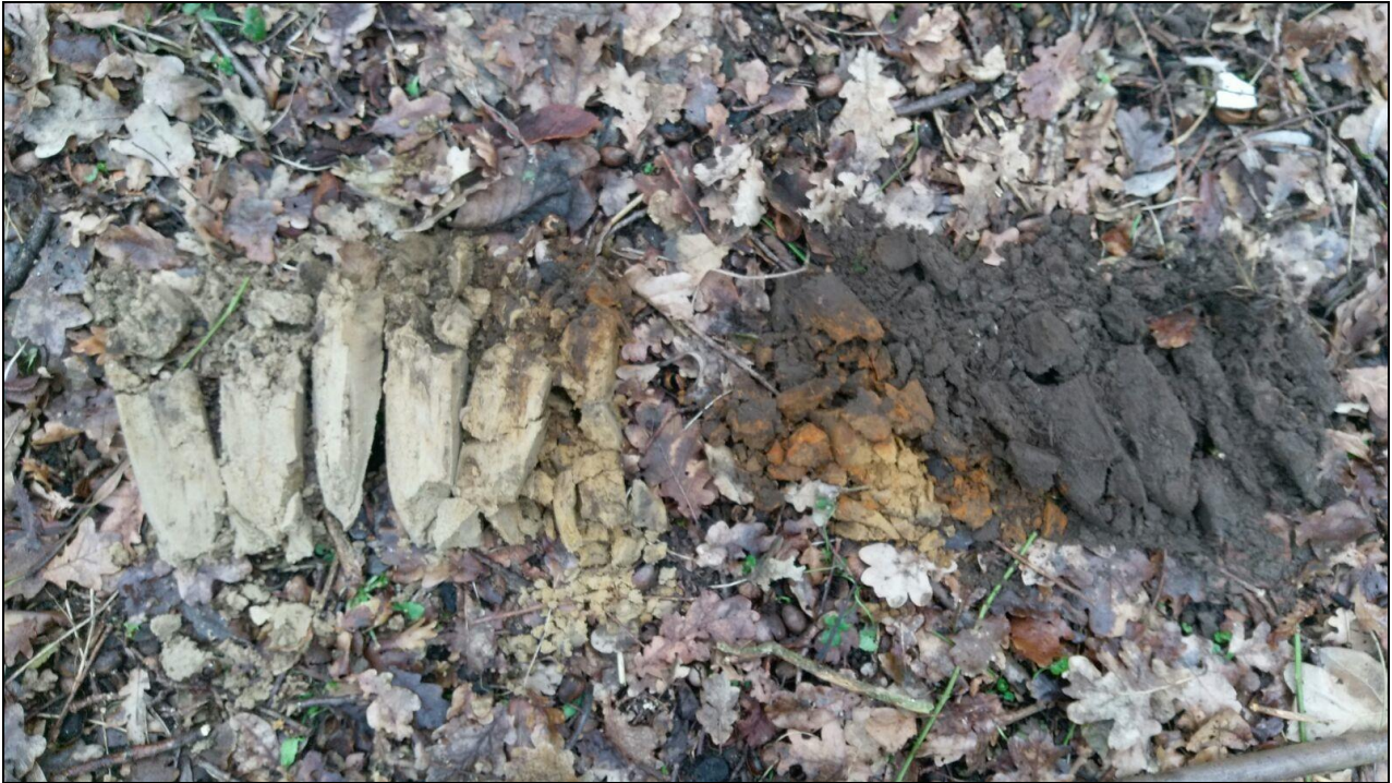
Figuur 10: Het profiel van boring 5 met het restant van een B-horizont.
