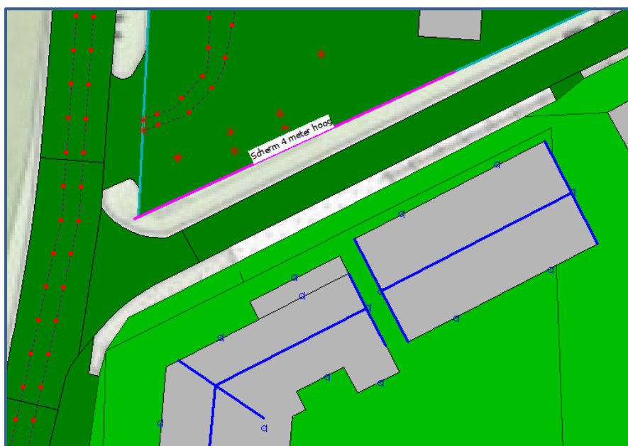
Afbeelding 6. Afschermdende voorziening (minimaal 3,6 meter hoog)
