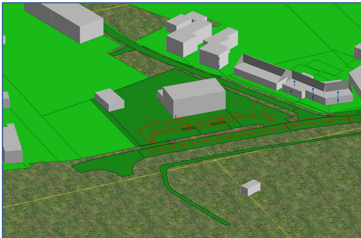
Afbeelding 4. Rekenmodel, 3d-weergave (toetsing bestaande woningen)
