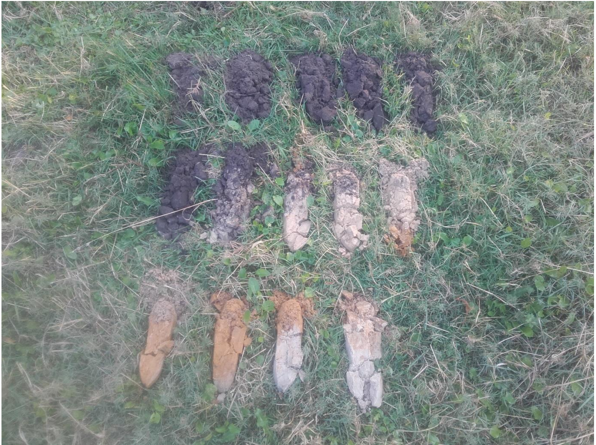
Afbeelding 8 Boring 4195002, met ijzerneerslag in de C-horizont (het oranje-gekleurde bereik vanaf midden-rechts tot centraal onderin het opgeboorde materiaal op deze foto. Foto: Vestigia). Zie voor ligging van deze boring kaart 2 ; de beschrijving is na te lezen in bijlage 2 .
