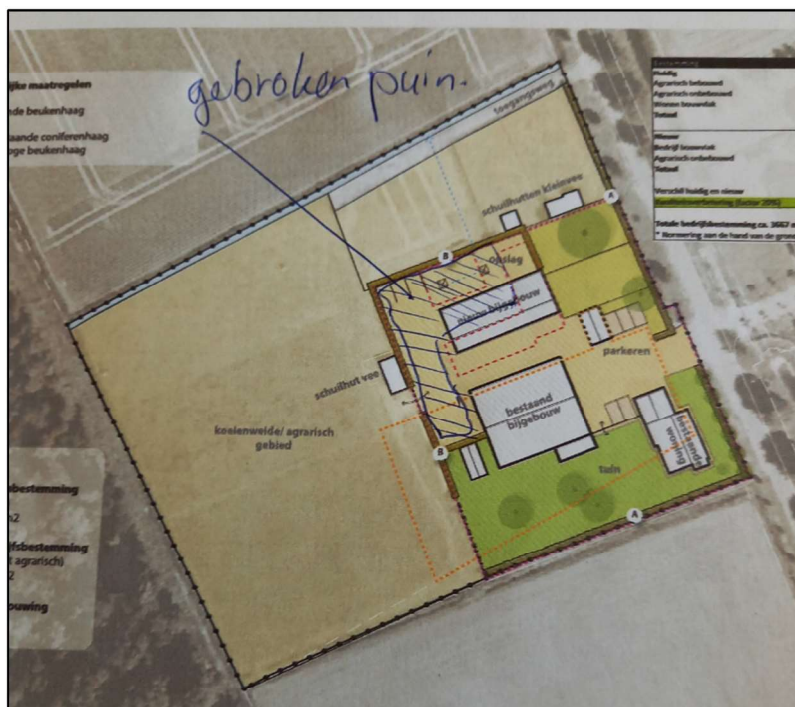
Figuur 3. Locatie waar puin is toegepast aangeleverd door de opdrachtgever.
