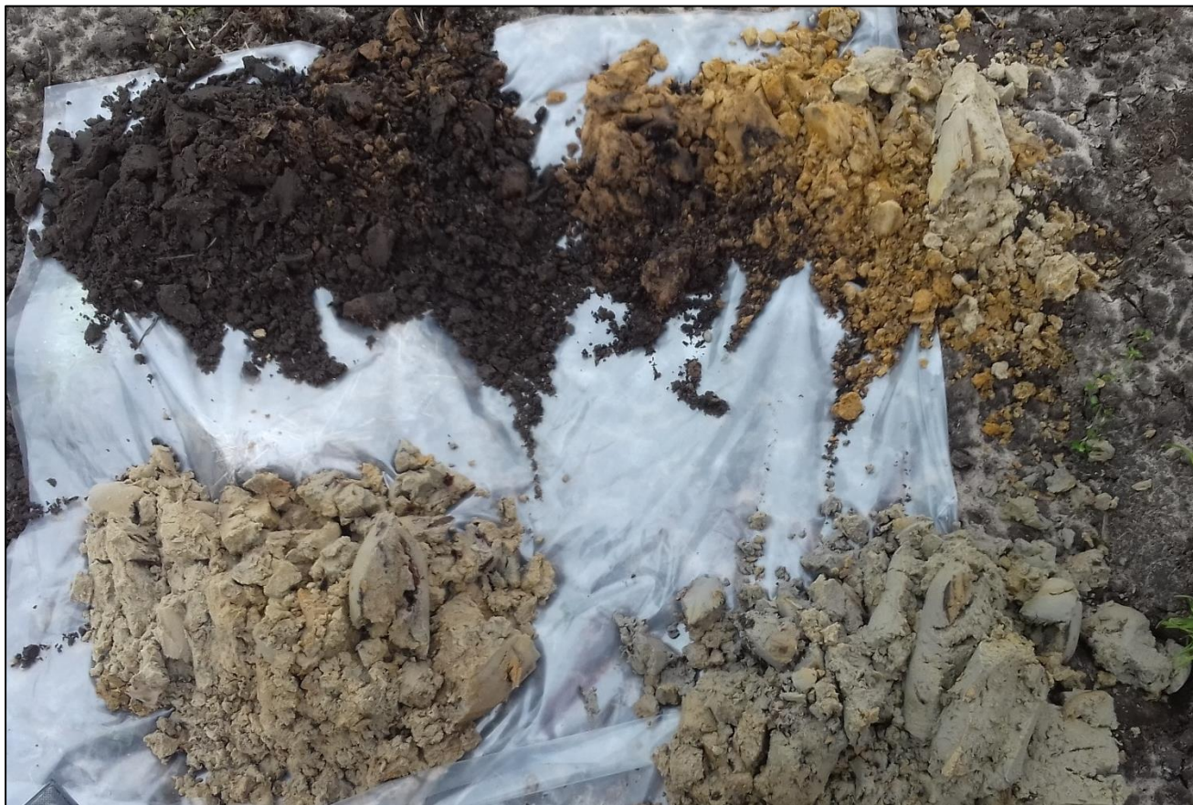
Figuur 7. Boorprofiel boring 5. De leesrichting is van linksboven naar rechtsonder.
