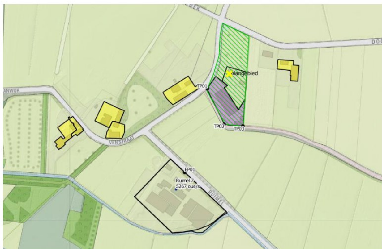
Afbeelding 6. Emissiepunten en toetspunten voorgrondbelasting
