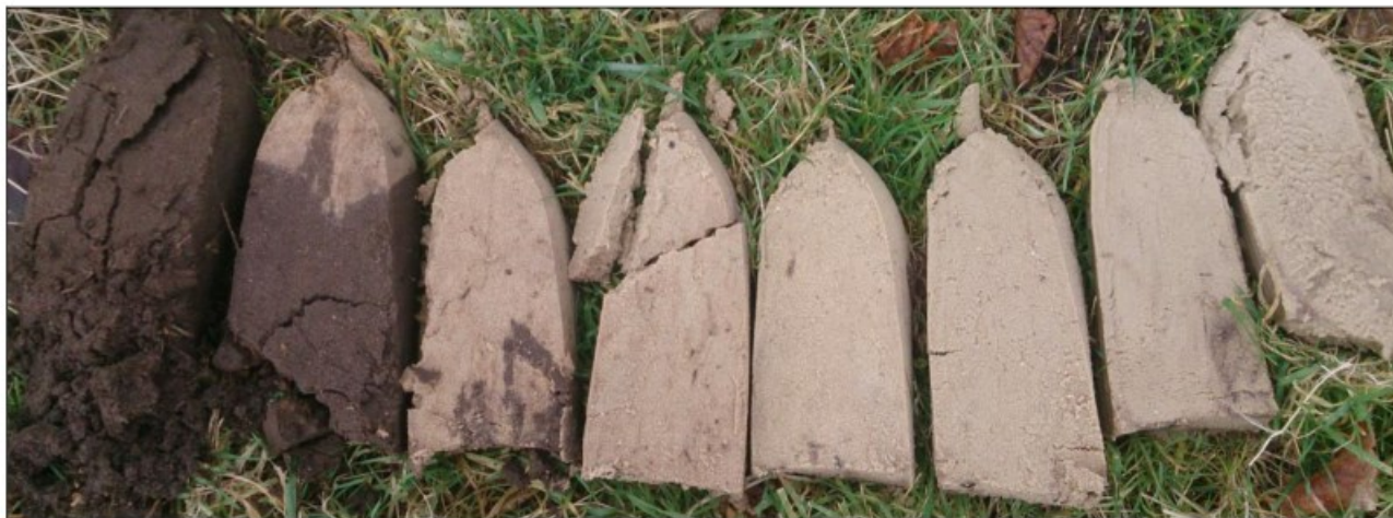
Figuur 5: het profiel van boring 3 met scherpe overgang tussen de Ap- en C-horizont.
