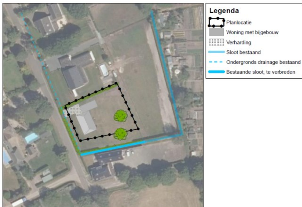
Figuur 14: Beoogde inrichting planlocatie met hemelwaterafvoer
