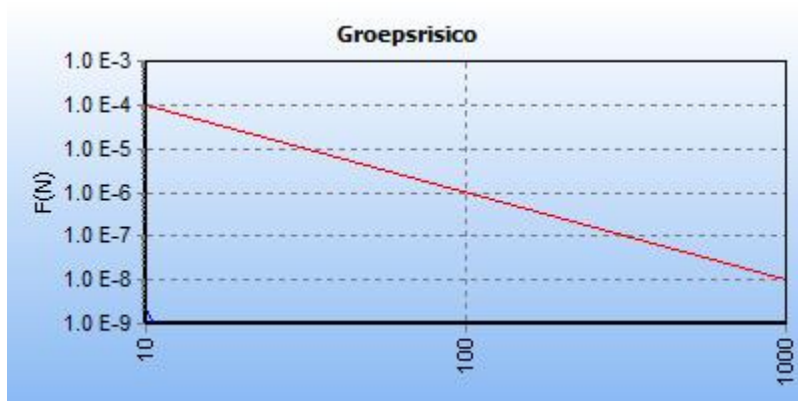
5.2 Figuur 5.2 FN curve voor 8202_leiding-A-526-deel-1 van N.V. Nederlandse Gasunie voor de kilometer tussen stationing 890.00 en stationing 1890.00
