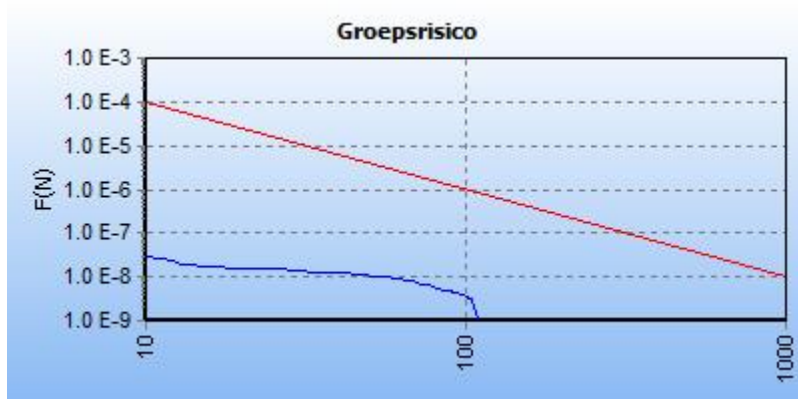
5.3 Figuur 5.3 FN curve voor 8202_leiding-A-527-deel-1 van N.V. Nederlandse Gasunie voor de kilometer tussen stationing 2490.00 en stationing 3490.00
