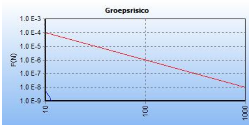
5.2 Figuur 5.2 FN curve voor 8202_leiding-A-526-deel-1 van N.V. Nederlandse Gasunie voor de kilometer tussen stationing 890.00 en stationing 1890.00
