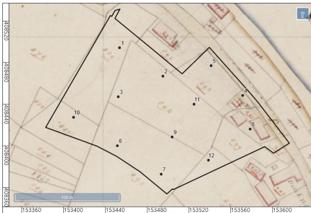
Figuur 28: Boorpunten ten opzichte van het kadastraal minuutplan uit de 19e eeuw. Boring 9 is waarschijnlijk in een gedempte sloot gezet.
