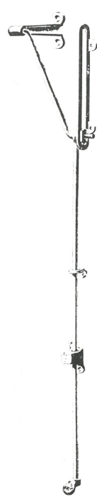
247 "Transom". Voor tuimel-, val- of klepramen. De verkoperde ijzeren schuifstang waarmee je het raam opent, is bevestigd op de kozijnstijl of op de stijlbetimmering.
