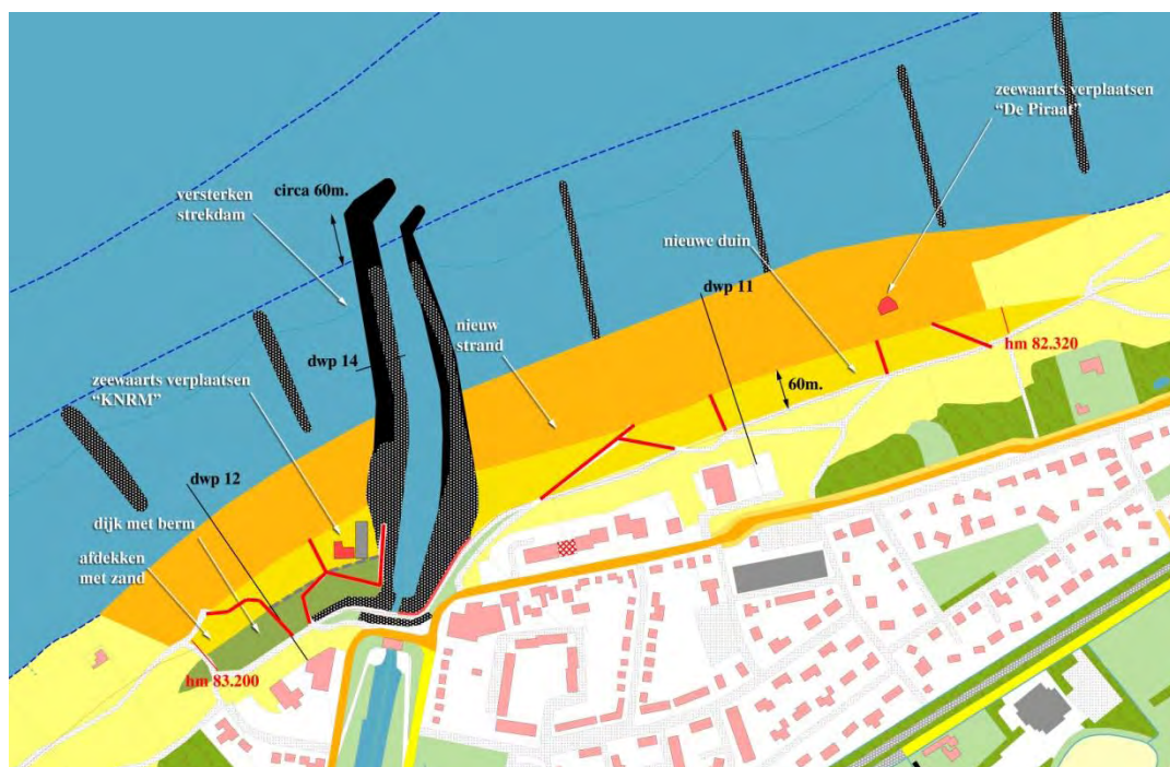
Figuur 2.4: Principe ontwerp Cadzand-Bad uit Kustversterkingsplan (KVP), DHV et al (2007).
