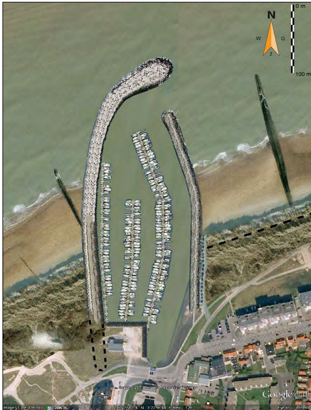
Figuur 3.1 Voorkeursalternatief kustversterking en jachthaven [Svašek Hydraulics, 2012]
