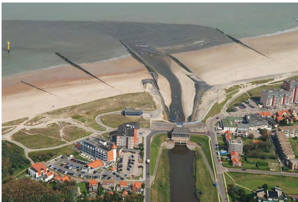
Figuur 6.10: Uitwatering onder vrij verval.
