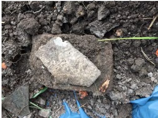
Asbestverdacht materiaal ter hoogte van proefgat 020
