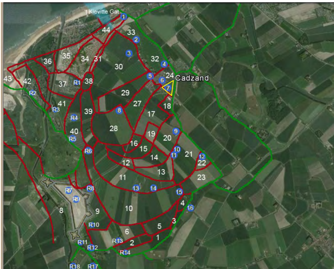
Afbeelding 7. Ommeloperkaart geprojecteerd op een luchtfoto. In geel is de contour van het plangebied weergegeven. De rode lijnen geven de dijkjes, kades en wegen aan die poldertjes begrensd. De groene lijnen geven de ligging van de c. 2,5 meter hoge dijken die de poldertjes tegen grote overstromingen moesten beschermen. Bron: http://www.cadzandgeschiedenis.nl/images-1400/1112oudelandsepolder.html
