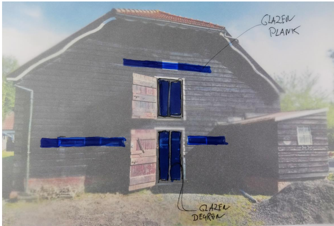
Figuur 7: schets zijkant schuur na verbouwing
