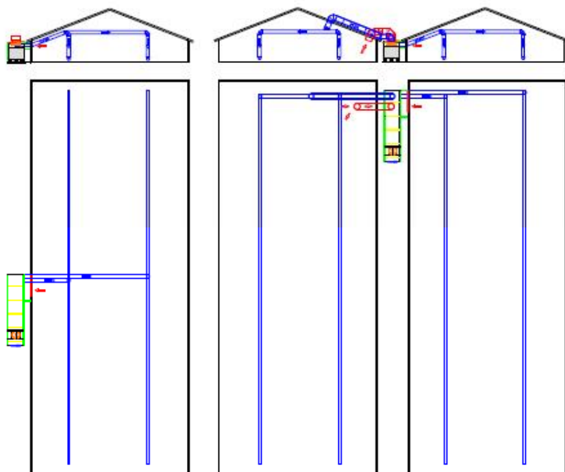
Plattegrond en dwarsdoorsnede bij toepassen van warmtewisselaar met buizen systeem
