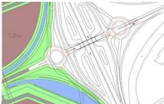
Figuur 2 Ontwerp aansluiting N7. Links De Hemmen III, rechts De Hemmen I&II
