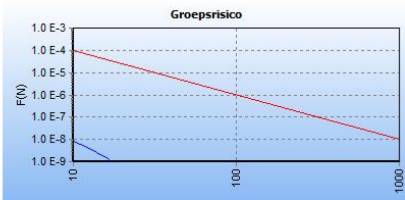
Figuur 2.2 FN curve voor 6618_leiding-A-546-deel-1 van N.V. Nederlandse Gasunie voor de kilometer tussen stationing 2350.00 en stationing 3350.00
