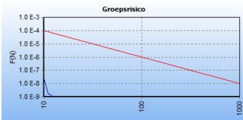
Figuur 2.3 FN curve voor 6618_leiding-A-545-deel-1 van N.V. Nederlandse Gasunie voor de kilometer tussen stationing 700.00 en stationing 1700.00
