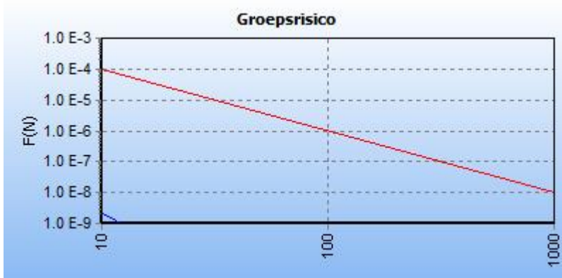
Figuur 2.1 FN curve voor 6618_leiding-A-652-deel-1 van N.V. Nederlandse Gasunie voor de kilometer tussen stationing 2410.00 en stationing 3410.00
