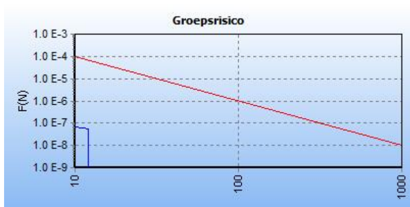
Grafiek 1.1 FN curve voor 6633_leiding-A-546-deel-1 van N.V. Nederlandse Gasunie voor de kilometer tussen stationing 3190.00 en stationing 4190.00
