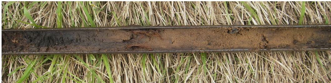
Figuur 7. Woudsend, Vosseleane. De overgang tussen veen (links) en dekzand (rechts) zoals deze in de boringen 4 tot en met 7 en 10 tot en met 13 is aangetroffen.
