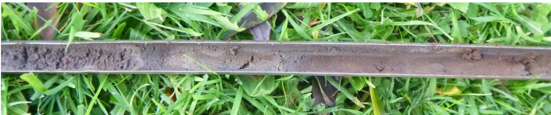
Figuur 6: Koudum, Wetterbies. De BC-horizont (rechts) zoals deze op de boorpunten 1, 4, 6 en 12 direct onder de toplaag van vergraven/opgebracht zand is aangetroffen.
