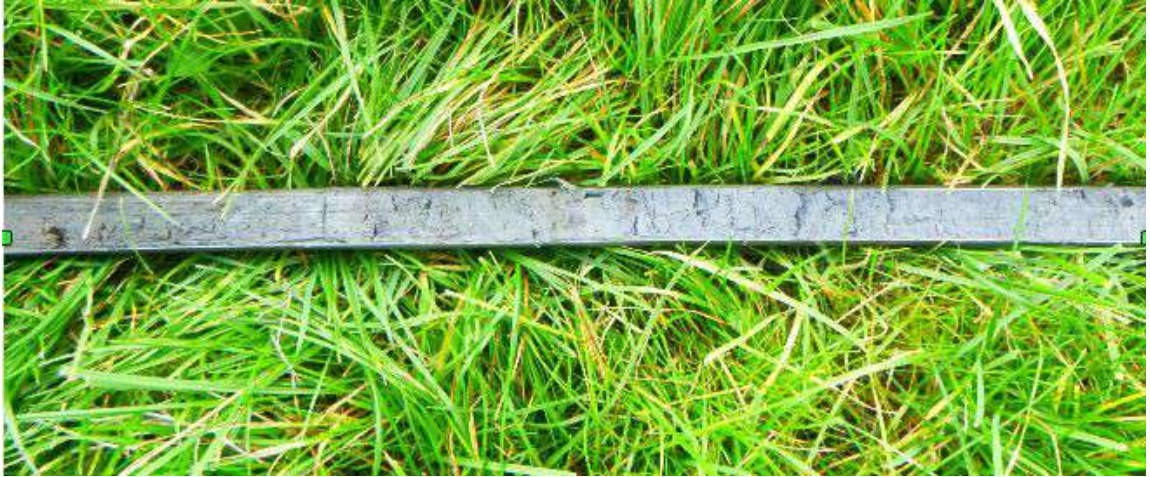
Figuur 13: Arum, Franekerkade 21: Het door dunne zandlaagjes onderbroken kleipakket dat op alle boorpunten doorloopt tot tenminste drie meter beneden het maaiveld.
