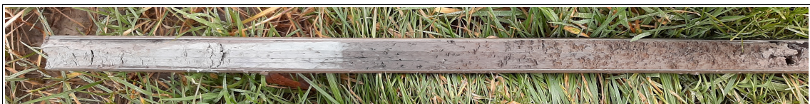
Figuur 13: Hichtum, Schwarzenbergweg: gutsmonster boring 5 van 70 (rechts) tot 130 centimeter (links). Het monster vertoont een scherpe kleurovergang op 105 centimeter. Links daarvan ligt grijze, ongeroerde, natuurlijke klei. Rechts van de kleurovergang is de daarop liggende geroerde, bruinigrijze klei zichtbaar.
