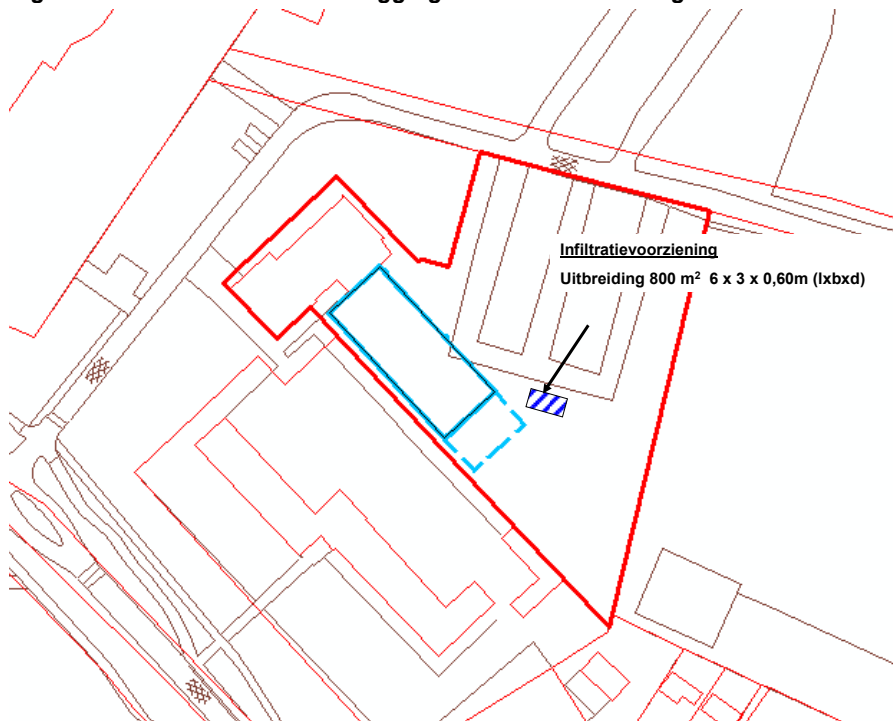
Figuur 4.1 Voorstel indicatieve ligging infiltratievoorziening
