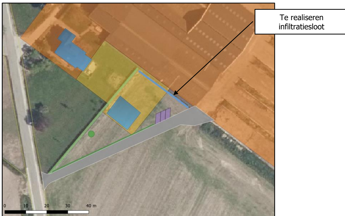
Afbeelding 15: weergave beoogde locatie voor te realiseren infiltratiesloot
