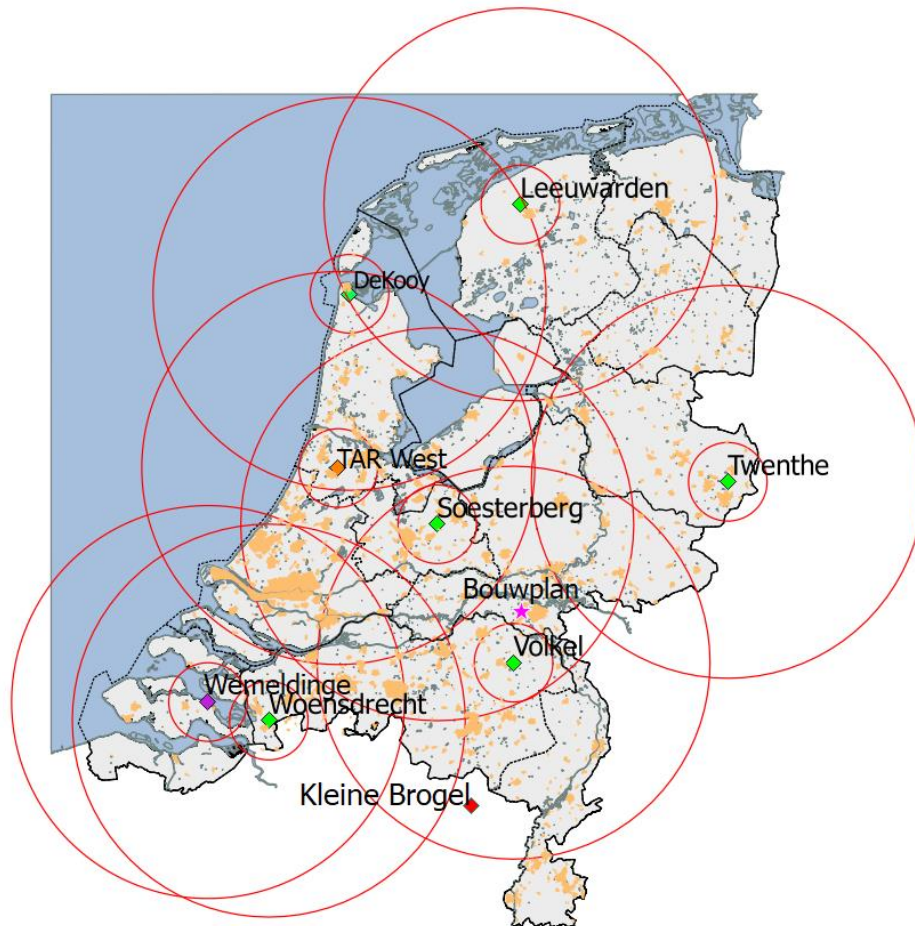
Figuur 3 Locaties van de zes MASS verkeersleidingsradarsystemen (groene ruit) met daaromheen de 15 en 75 km cirkels. De TAR West radar bij Schiphol is aangegeven met een oranje ruit, de infill radar te Wemeldinge met een paarse ruit en de ondersteunende radar Kleine Brogel met een rode ruit.. De oranje vlakken zijn de in de AHN-1 gedefinieerde stedelijke gebieden. De ligging van het te toetsen bouwplan is aangegeven met een roze ster.
