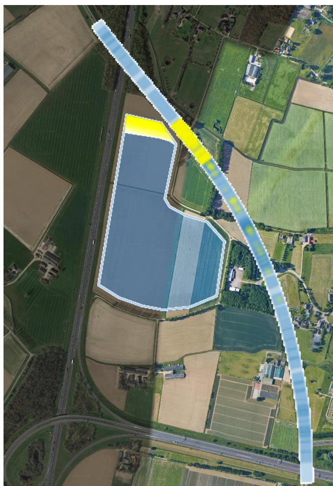
Figuur 4.2: Schitterende delen van de zonnepanelen, zichtbaar vanaf de Hernenseweg en de plekken op de route waar de reflectie tot hinder leidt. Hoe geler de kleur, hoe meer reflectie.
