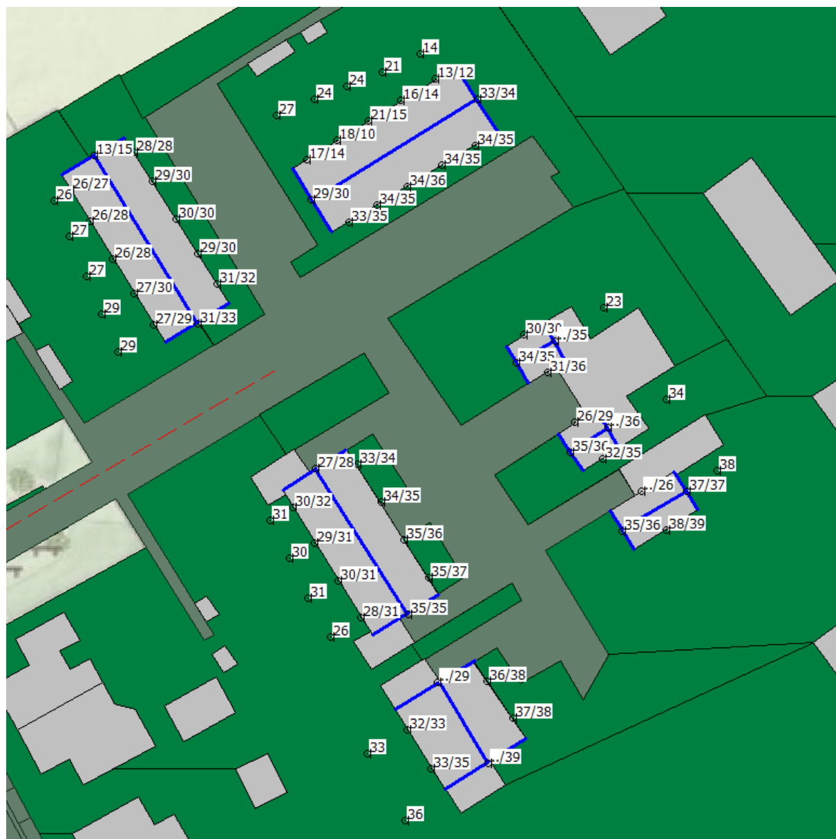
Afbeelding 6. Geluidbelastingen L_{den} (incl. aftrek art. 110g Wgh) Wijksestraat Berekende geluidbelastingen op een hoogte van 1,5 / 4,5 meter
