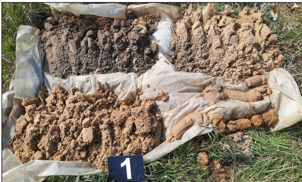
Afbeelding 4: Profielboring 1 vanaf maaiveld (linksboven) tot 2,4 meter onder maaiveld (rechtsonder).
