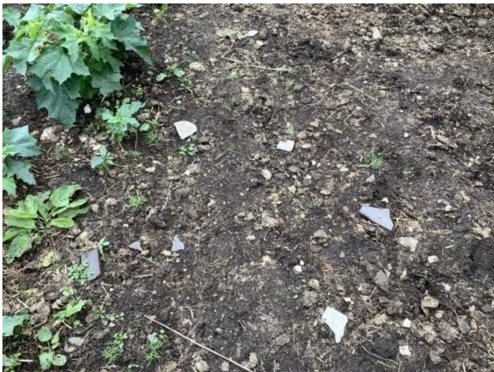
Asbest op maaiveld
