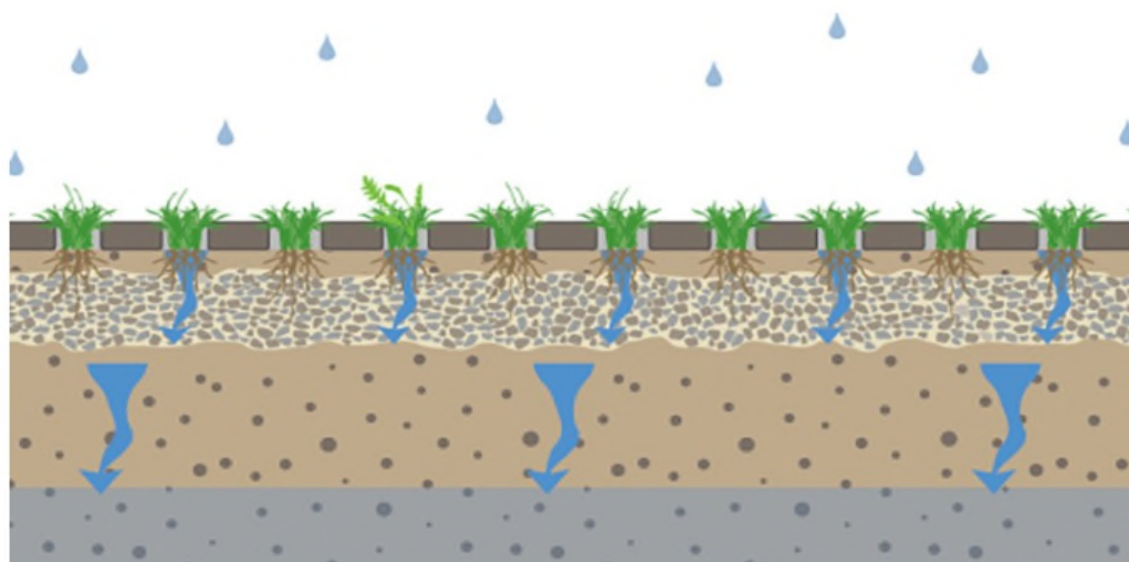
Schematische doorsnede van grasbetonstenen. ©Atelier GROENBLAUW
