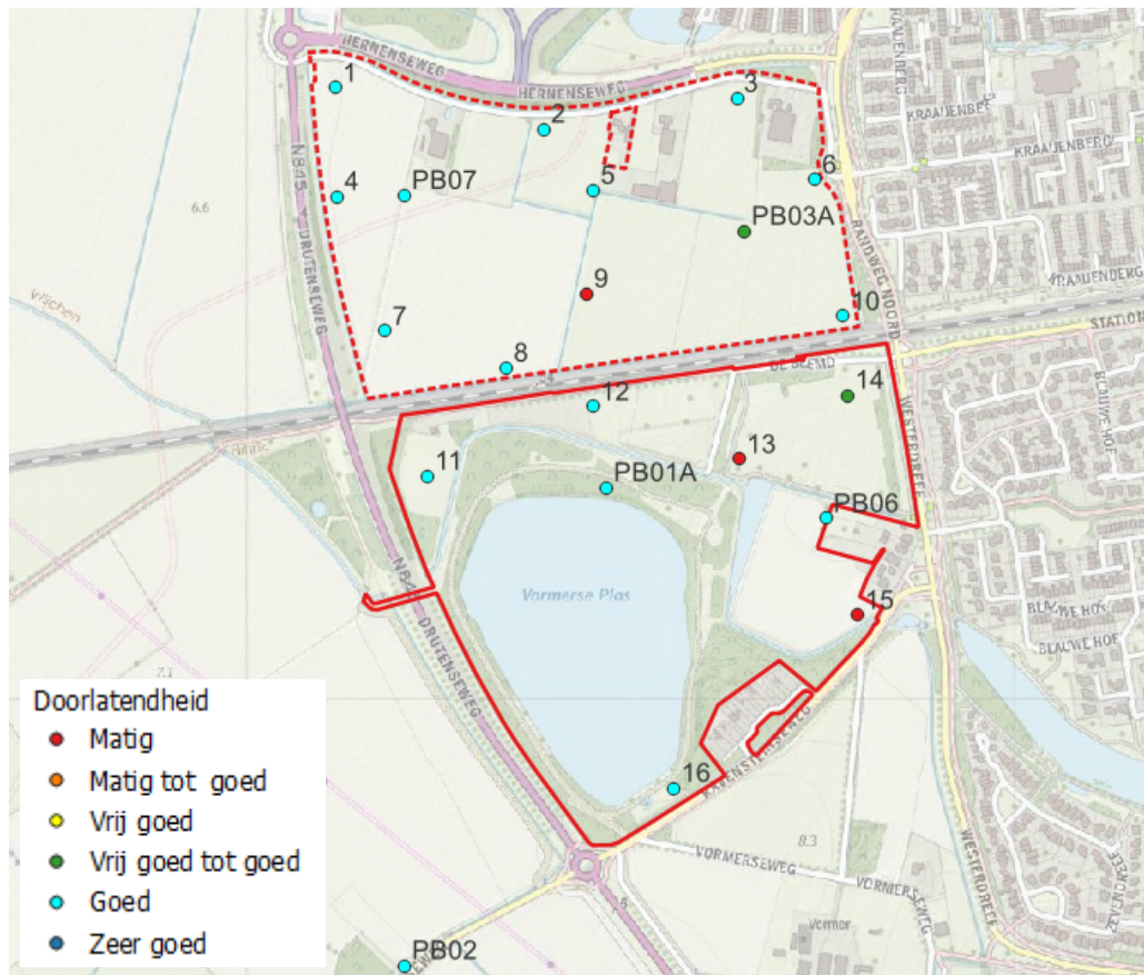
Figuur b. Classificatie van de k-waarde voor infiltratieproeven vanaf maaiveld tot een diepte van 1,0 m onder maaiveld.
