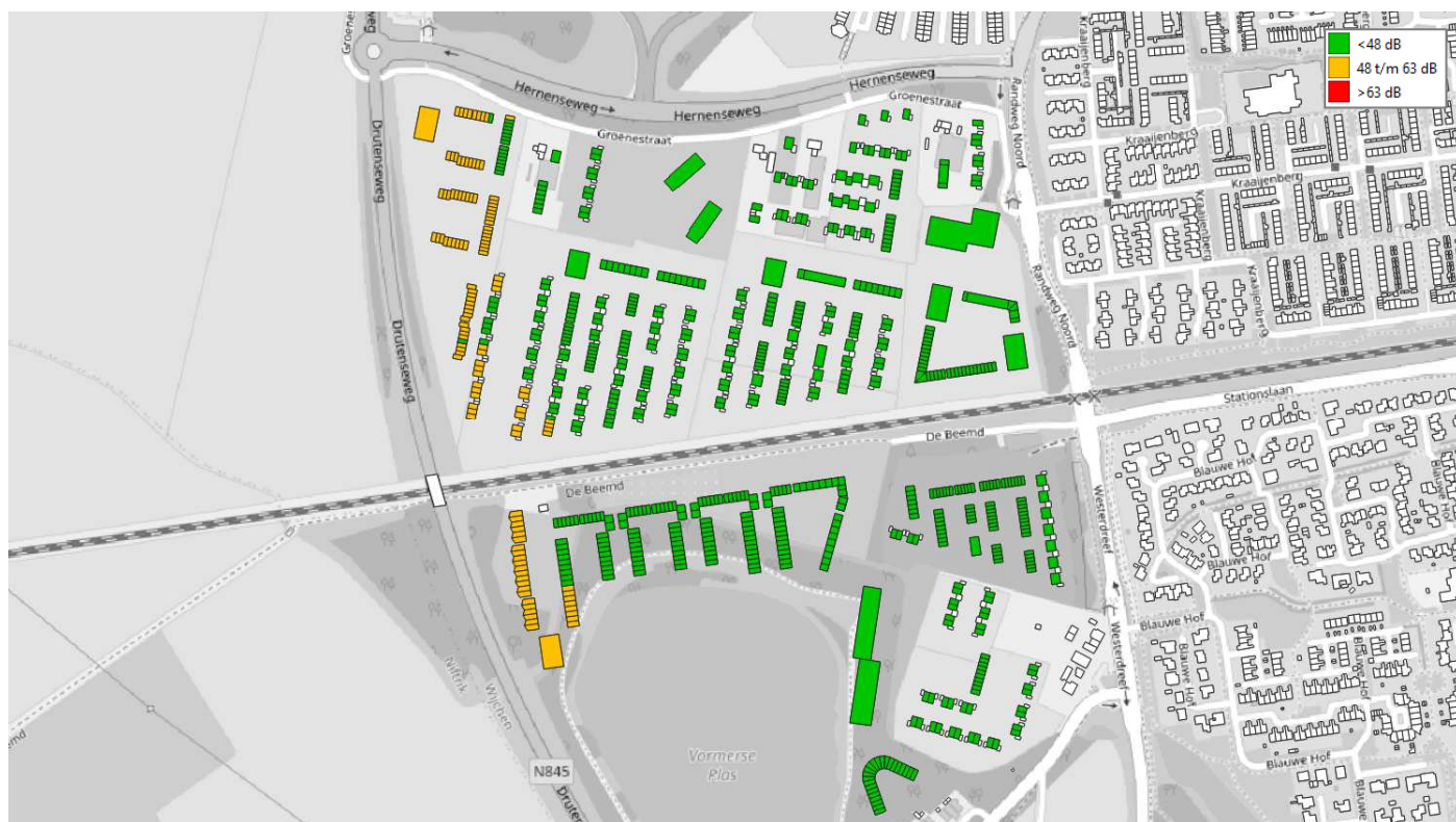
Figuur 6.8: Geluidsbelasting t.g.v. N845 op voorlopige verkaveling – met stil asfalt (inclusief correctie artikel 110g Wgh.)
