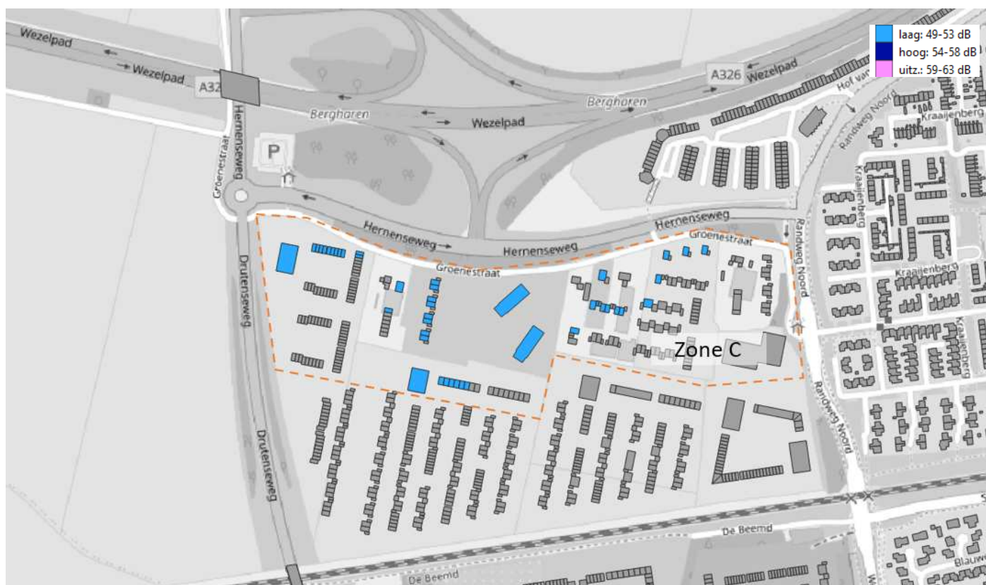
Figuur 6.16: Benodigde categorieën hogere waarden t.g.v. A326 Wezelpad – met afscherming
