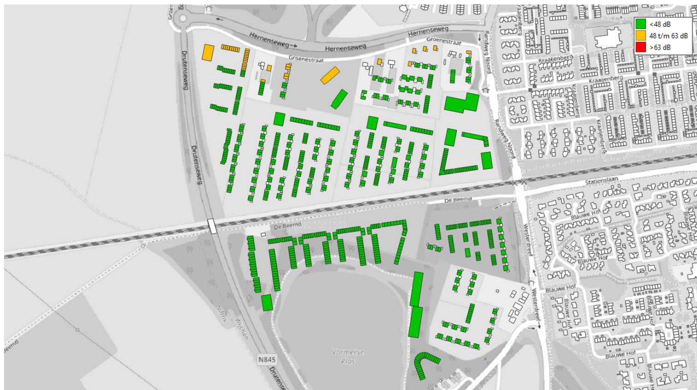
Figuur 6.6: Geluidsbelasting t.g.v. Hernenseweg op voorlopige verkaveling – met stil asfalt (inclusief correctie artikel 110g Wgh.)
