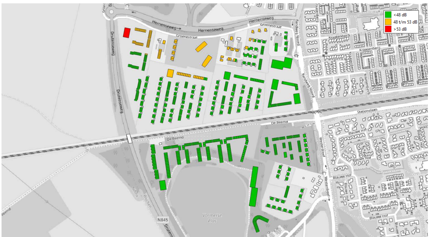
Figuur 6.4: Geluidsbelasting t.g.v. A326 Wezelpad op voorlopige verkaveling – met stil asfalt (inclusief correctie artikel 110g Wgh.)
