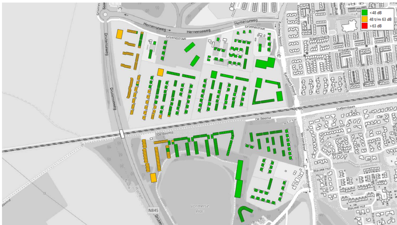
Figuur 5.7: Geluidsbelasting t.g.v. N845 Drutenseweg op voorlopige verkaveling (inclusief correctie artikel 110g Wet geluidhinder)
