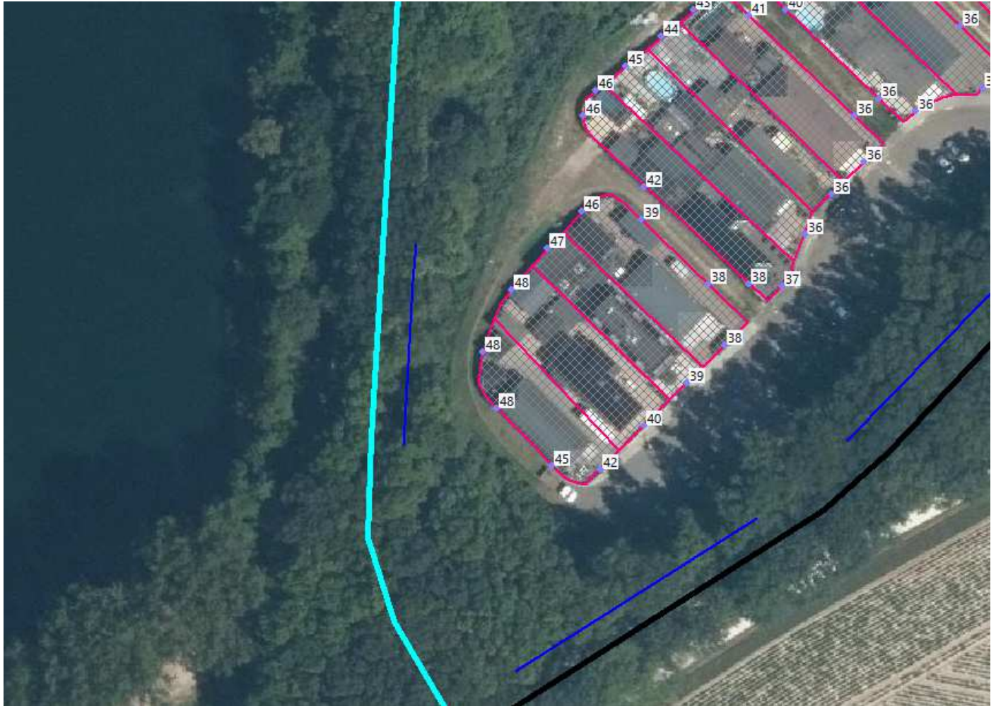
Figuur 6.12: Geluidsbelasting t.g.v. nieuwe ontsluitingsweg – met afscherming (inclusief correctie artikel 110g Wgh.)
