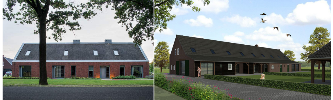
Impressies voor de toepassing van dakramen. De ramen worden zodanig geplaatst dat de bindende werking van het dakvlak in tact blijft.
