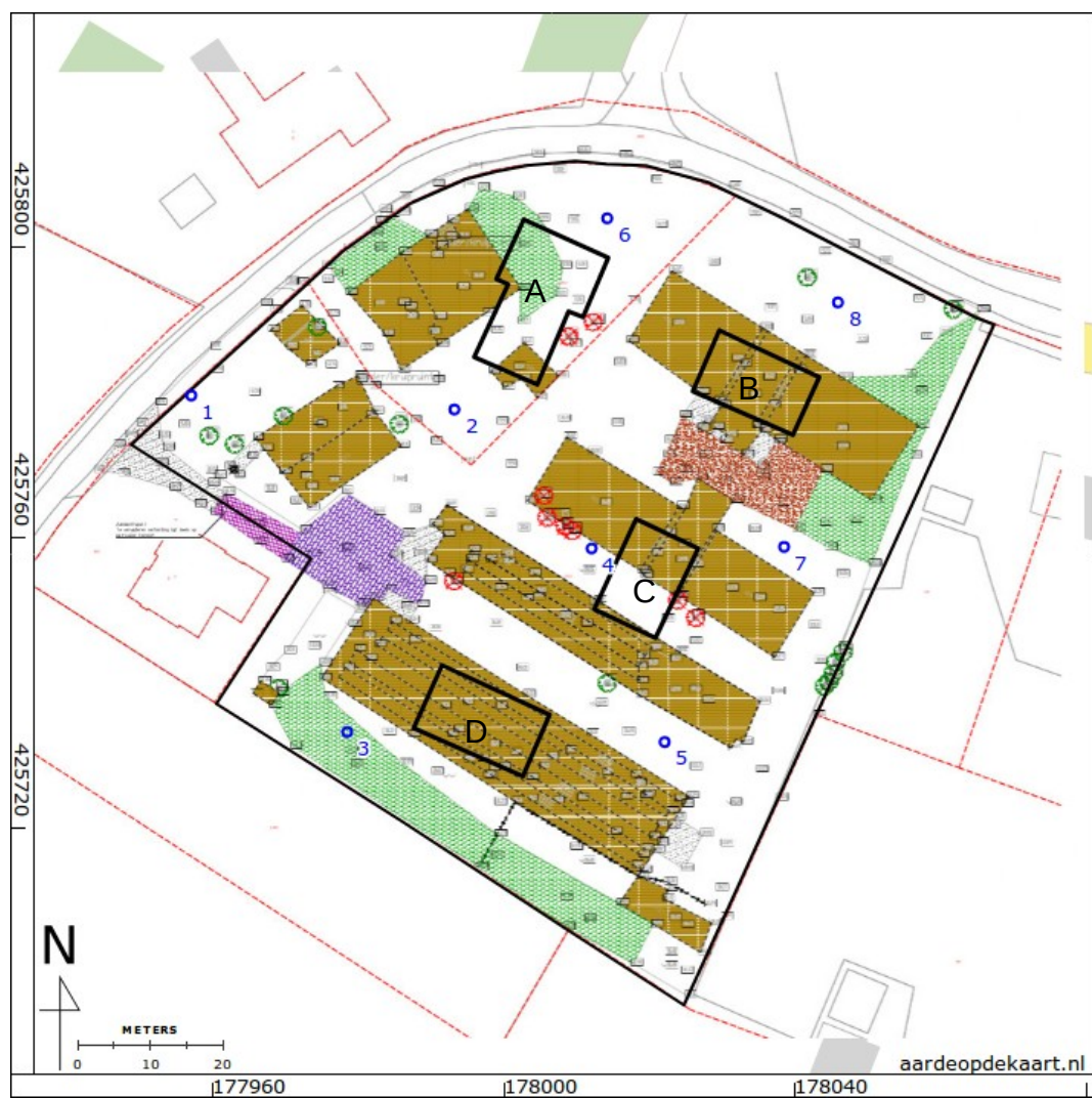
Figuur 28: Oude situatie, nieuwe bouwvlakken en boorpunten.
