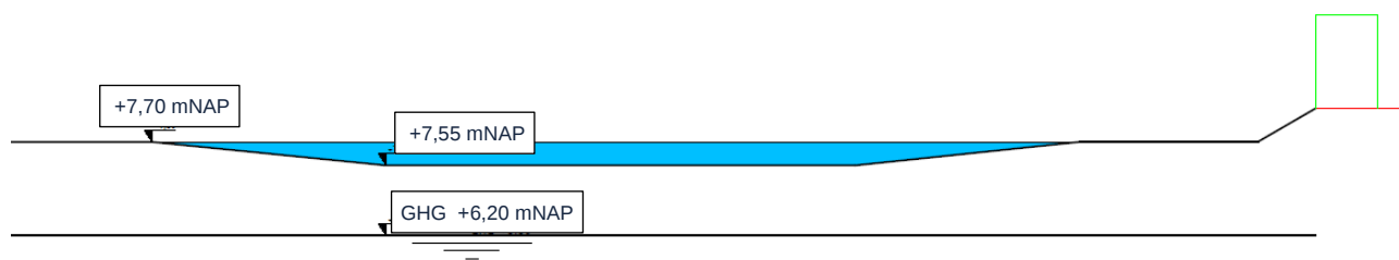
Afbeelding 8: Principe doorsnede infiltratieveld
